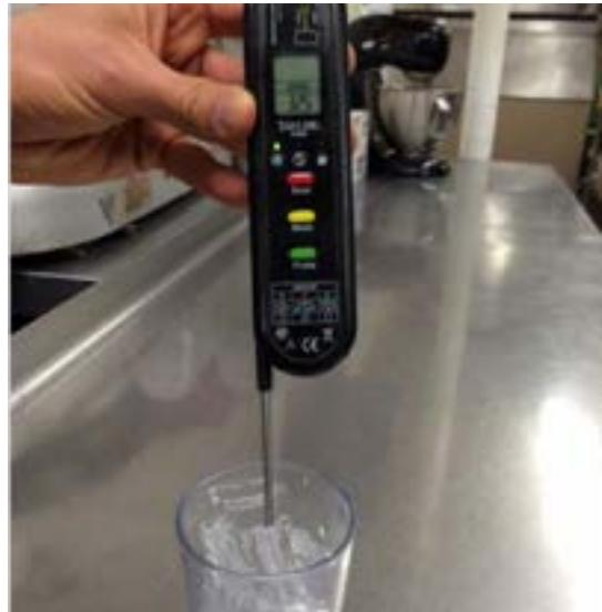
已校准的金属制温度计
